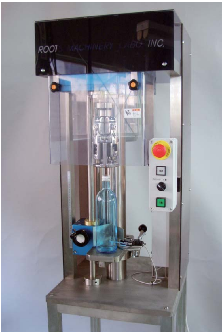
(伊) シエムのヘッド。オールステンレス製。一般によく使われる 30mmSTD 用ヘッド (写真左) のほか、ロング PP、ステルキャップ、ステルヴァンなどのヘッド (写真右) も可能。
