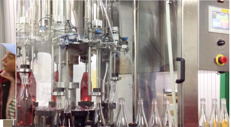
← ↓ G-TRON 9 スパークリングワイン充填機 大阪・Kワイン 納入機 (打栓機のない、充填機だけのモデル) "K" winery, Osaka, Japan
