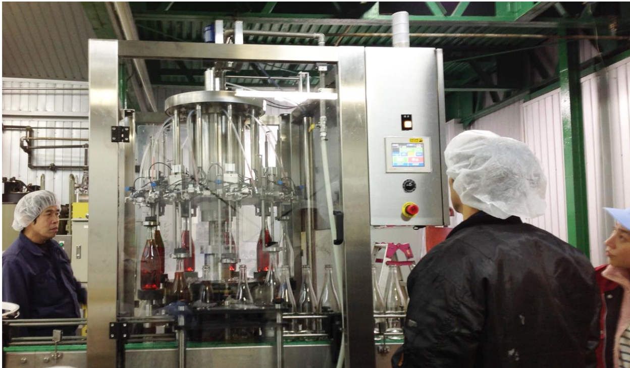
← ↓ G-TRON 9 スパークリングワイン充填機 大阪・Kワイン 納入機 (打栓機のない、充填機だけのモデル) "K" winery, Osaka, Japan
