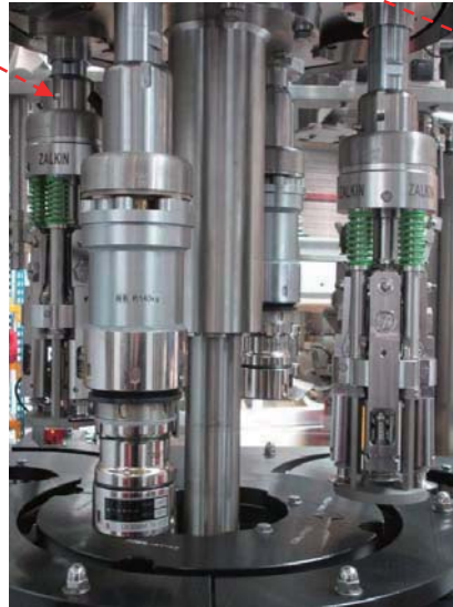
ZALKIN 104SUS ロールオンヘッド 2 基と、平和打栓 (クリンピング) ヘッド 2 基を搭載。
