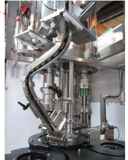
ホッパーから下降するキャップシュートは固定。キャップキャッチャーはクイック交換システムで、型変えが簡単。
