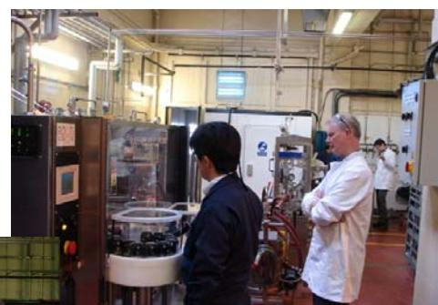
充填されたビールは充填量、DO、缶内圧、巻締め状態等、品質基準に合致しているか厳しくチェック。すべての項目で無事クリア！
