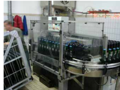
③次にパレットごと堀詰めライン横に持つてくる。写真は置二置ほどのネックフリーザー（＝堀口凍結機）に堀を逆さまのまま入れる人。右手に正立した堀がでてくる。
