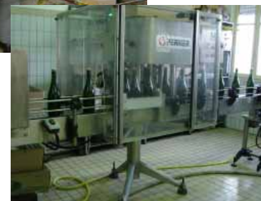
⑧あとは、キャップシールとラベルでできあがり。写真はキャップシーラー内部。シャンパンのキャップシールは正面に印刷が来るようになっているので、位置だしステーションがついている。
