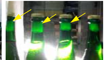
④ネックフリーザーで酵母が凍った状態はこんな感じ。このくらいの酵母量・凍結量が適正。
