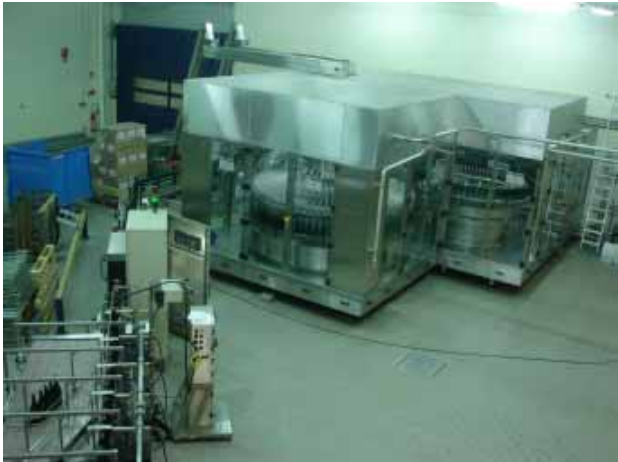
①次は業界最大級の工場を、ワイン充填機から見る。アッサンブラージュしたワインに、糖分、酵母、亜硫酸などを混合して充填。上部に二つの供給ラインがあるのは王冠用とビデュール用。
