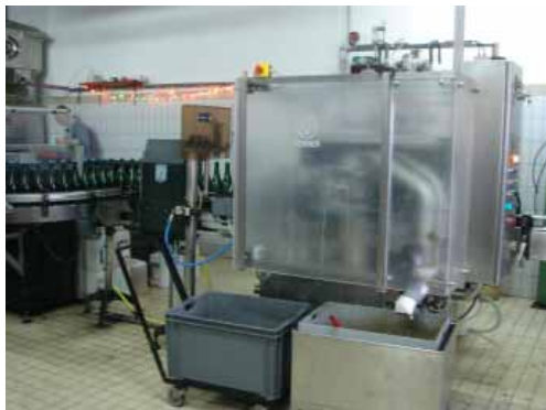
⑤「ディスゴーギング（＝王冠を抜いて、凍らせた酵母を吹き飛ばす工程）」の機械。右写真のように王冠のほか、ピデュールという酵母受けカップも排出される。
