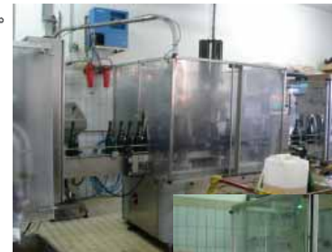
⑦「コルカー・ワイヤーフーダー」(左)と「ブレンディング（＝堀を倒立させてリキュールを攪拌する工程。これがないと不思議と混ざらない。）」の機械(左下)。
