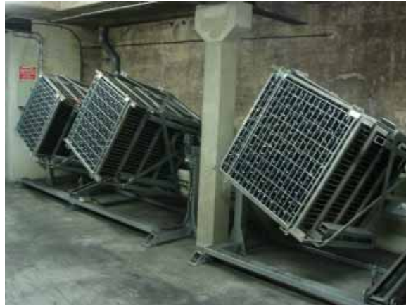
②約500本の堀が入ったパレットごと「ジャイロパレット」で「ルミューージュ（＝堀を回しながら立てていき、酵母を堀口に集める工程）。通常は7日程度で完了。シャンパーニュでは、いまや小規模でも堀を手で回している人はほとんど皆無という。
