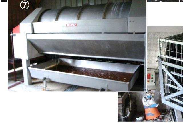
①「ドメーヌ・デュポン」の周りには整然と植えられたりんご畠。②③シードル用のりんごには数種類あるが、どれもこんなに小さい。地面に落ちた状態でしばらく熟成させる。④大型トラクターで集めたりんごはまずは水洗い。⑤緑色の機械が粉碎器。縦型オーガで筒内を上に移動させながら水切りし、最上部にある回転刃で粉碎。⑥こんな円筒形回転刃が内蔵されている。⑦デュポンではメンブランプレスで搾る。私はワイン用のメンブランプレスでりんごを搾った体験があるが、目詰まりして大変だった。たぶん、りんご専用に工夫されたプレスなのだろう。ワイン用のブーハーはフランス製だが、このブーハー・プレスはイスラブ製。⑧デュポンではびん内二次醸酵のシードルも作る。ジロパレットで澱を下げ、びん口を凍らせて澱を抜くのはシャンパーニュと同じ。
