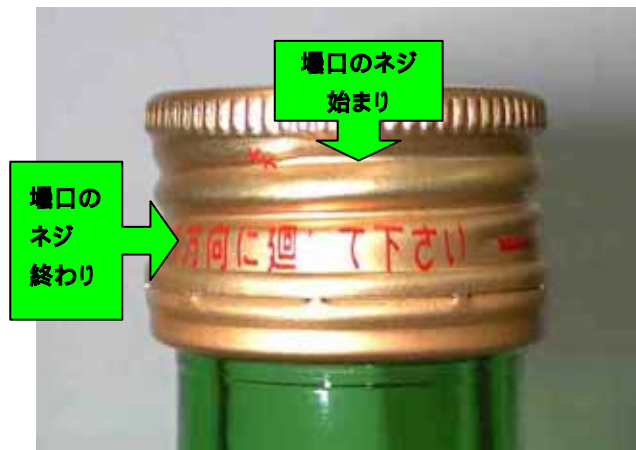
写真1. 正常な巻締めサンプル
