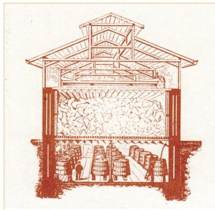
図4. 天然水で冷却された発酵・貯蔵室 (「ビール礼賛」より)
