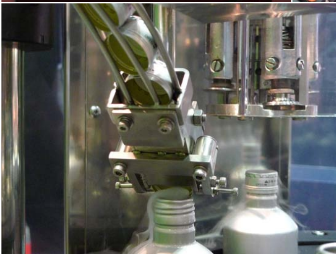
ボトル缶用にはフランス ZALKIN ヘッドを採用。(他のヘッドの搭載も可)
