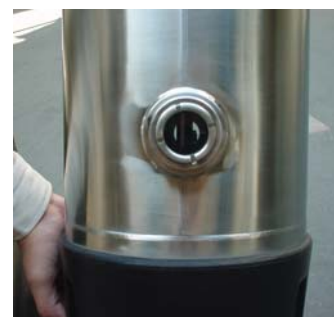
▲泡サイズが目視できる「窓」。泡サイズを極小にコントロールできるので、余分なガスを使わずにすむうえ、フレーバーやアロマを液外に逃がすリスクを最小限に抑えます。
