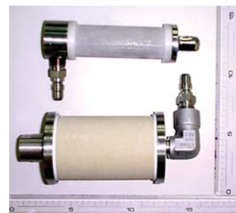
▲日本仕様は泡のサイズがより小さい「セラミックストーン」（下）が標準。（ステンレスストーン（上）もオプションで装着可能です。）
