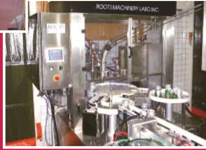
ラボ・小規模生産用缶詰機「ビアラディクス」 / "Beer Radix" 250 cph beer canner, by ROOTS
