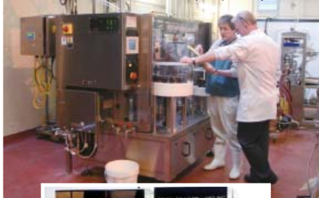
ラボ用液体窒素滴下装置付き缶詰機「BRX」 / "BRX" canner with LN2 doser for pilot plant, by ROOTS
