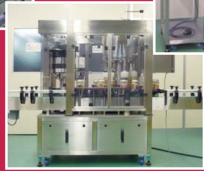
ノンガス飲料・缶詰機「TRON」シリーズ / Non-gas canner, LN2 doser capable, by ROOTS
