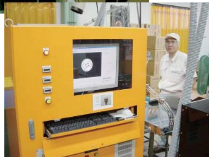
PPキャップの 画像処理検査装置 (大阪工場)
