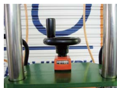
高さカウンター付きのヘッド昇降ハンドル 充填ヘッドと打栓ヘッドは独立に調整可能
