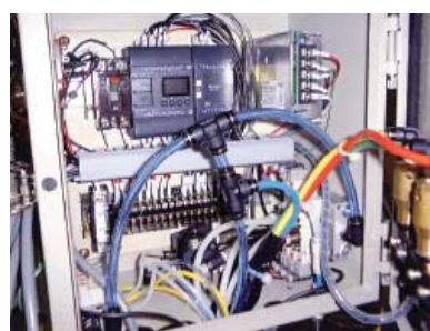
コントロールボックス内のプロコンと制御装置 シリーズIVになってプログラムも一新
