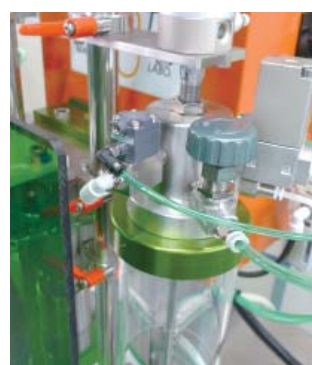
シリーズIVバルブ：ボタ落ち防止専用バルブを追加 作業性が大きく向上
