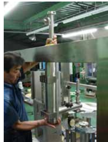
推奨仕様の VBC 社の滴下装置。液化窒素ボンベから「フレキシブルチューブ」で「滴下ヘッド」(上と右の写真。きわめてコンパクト)を連結するだけ。固定配管工事や窒素ガス配管は必要なく、簡単にセットアップ可能。「コントロールユニット」(左写真の中央)の操作もきわめてシンプル。(既存の滴下ヘッドを搭載することも可能です。最大許容ヘッドサイズ: 300mm)
