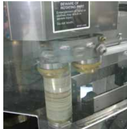
シーミングヘッド・アッセンブリー。1st ローラー、2nd ローラーが各1個。(ボトル缶のキャッパーも搭載可能です。)
