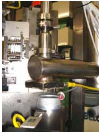
充填が終わった缶をスイングアームでつかんで、液体窒素滴下機の下をすばやく通過させる。写真は滴下の瞬間。
