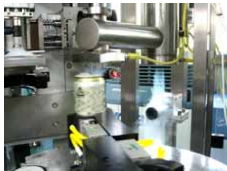
推奨仕様の VBC 社の滴下装置。液化窒素ボンベから「フレキシブルチューブ」で「滴下ヘッド」(上と右の写真。きわめてコンパクト)を連結するだけ。固定配管工事や窒素ガス配管は必要なく、簡単にセットアップ可能。「コントロールユニット」(左写真の中央)の操作もきわめてシンプル。(既存の滴下ヘッドを搭載することも可能です。最大許容ヘッドサイズ: 300mm)
