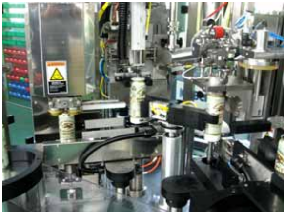
右端に少し見える缶の部分「エアリンス」工程、次が「カウンタプレッシャ充填」工程、次が「蓋のせとアンダーカバーガッシング」工程、左端が「蓋巻き締め」工程。(写真は「右投入 左排出」モデル)
