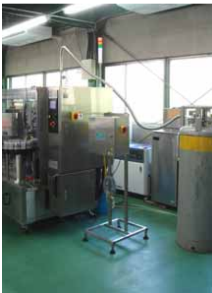
右端に少し見える缶の部分「エアリンス」工程、次が「カウンタプレッシャ充填」工程、次が「蓋のせとアンダーカバーガッシング」工程、左端が「蓋巻き締め」工程。(写真は「右投入 左排出」モデル)
