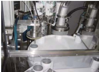
▲ 左から時計回りにエアリンス、充填、蓋供給、ガッシング、蓋巻き締め。充填。Actual picture of right hand layout.
