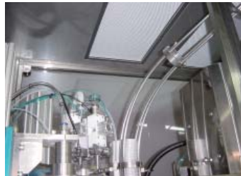
▲ (オプション) ISO クラス 5 のクリーンエア発生装置とクロージングブース Optional HEPA filter on top.
