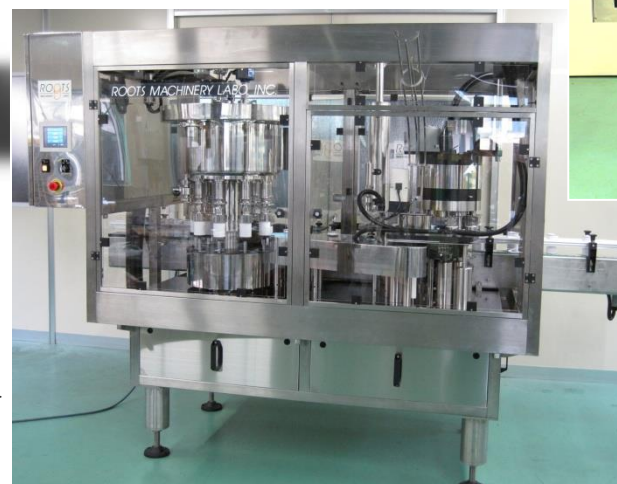
TRON 9-3c 缶詰め機→ (ガーター(樋)つき仕様) 液体窒素滴下オプション付き 一部特注仕様 Filler-canner monoblock, with gutter, inc. optional LN2 doser and some special feature
