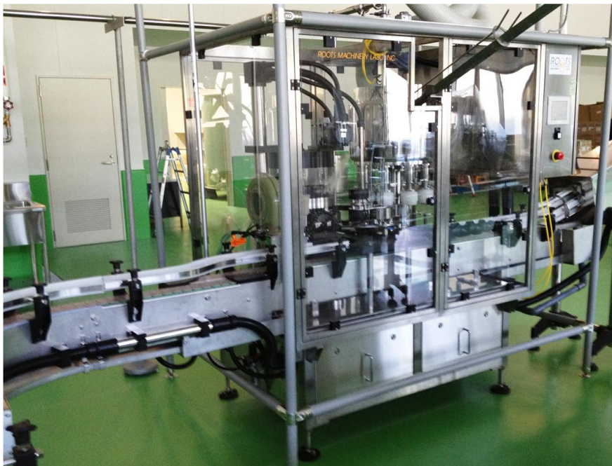
← TRON 9-3C 清酒缶詰め機 岩手・S 酒造納入機 "S" Sake brewery, Iwate, Japan
