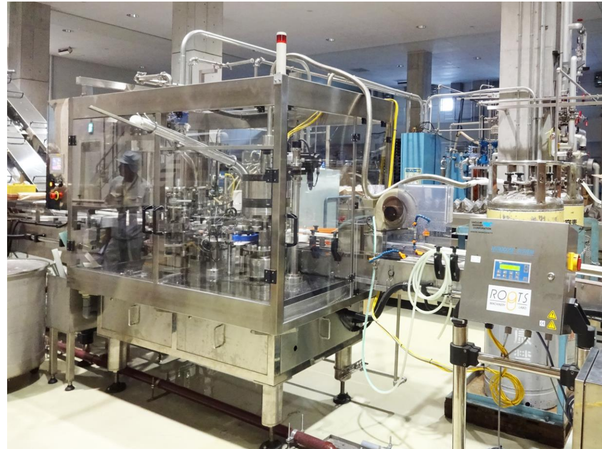
TRON 9-2X2C SPECIAL 清酒缶詰め機 → 兵庫・T 酒造納入機 液体窒素滴下装置つき 2 種類の缶対応の特別仕様 "T" Sake brewery, Hyogo, Japan
