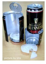
数年前まで使われていたディスク タイプ。日本では「UFO という名前 で広告されていた。缶底に固定さ れた状態、すなわち液中に沈んだ 状態で使用される。
