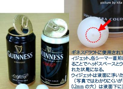
ギネスドラウトに使用されているフローティングウ イジェット。缶シーマー直前に液体窒素を滴下す ることでヘッパスペースとウィジェット内が加圧さ
