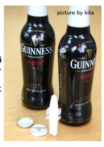
ギネスのパテントを避けた形で、イギリス のピールメーカーたちは各種のウィジェッ トの開発競争をしてきた歴史がある。 写真は、2000年ごろの Boddingtons の金 属製のフローティング widget。小さな容 器の上下に極く小さな穴の開いたプラス チックバルブが付いている。(写真は真っ 二つにカットしてある。)
