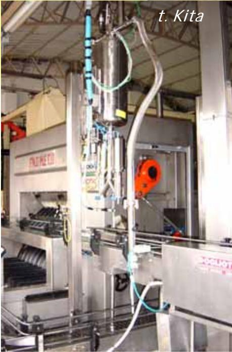
ピエモンテの某ワイナリーにて。壇充填の前にLN2滴下装置をつけている。
