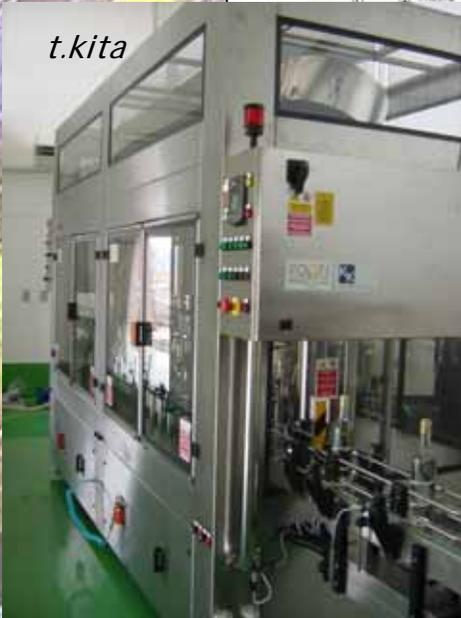
当社で施行した充填ライン。(Gワイナリー)12/14/1/1、2000bph。フィルターボールは窒素雰囲気。壇内は充填前に窒素置換。コルクカーでは炭酸ガス吹き込み。なお、機械全体をクラス5のクリーンブースに。
