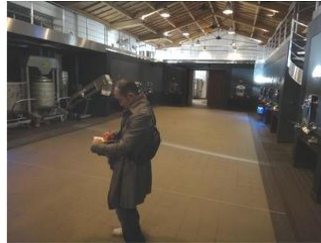
発酵後はこのバスケットプレスで搾り、地下の樽貯蔵室に、これまた重力式で流れていく仕組みとなっています。
