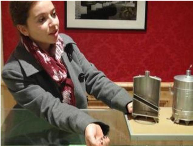
これが実際のそのタンク。上側のマンホールの裏にグリッドがついていて、液抜きはマンホールから行います。足場は開く構造になっており、下にはコンベアが配置されています。発酵後のモロミは、マンホールから取り出し、ポンプを使うことなくコンベアでプレス機へ。ポンプを利用するとワイン品質に悪影響を及ぼすと考えている様です。なお、写真はありますが、ラグランジュと同じブーハーのカメラによる自動選果システムが入っています。
