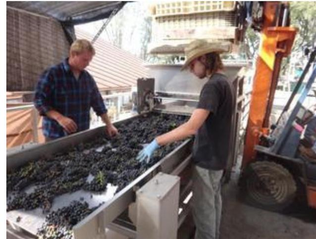
ちょうど、カベルネを選果、除梗の最中。ブドウはやはりプラスチックコンテナでハンドリング。コンベアを使ってクラスターの状態で 2 人が選果。主に、葉や大きな痛み部分をとる。そして、下に落として、、、
