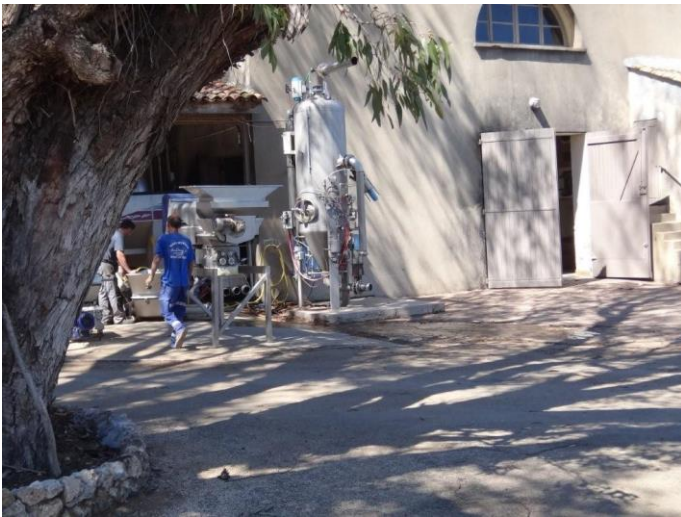
■酸素を使うのは、プロヴァンスでは一般的のよう。エノデヴのマイクロオキシジェネーション装置。複数のタンクを集中コントロール。
