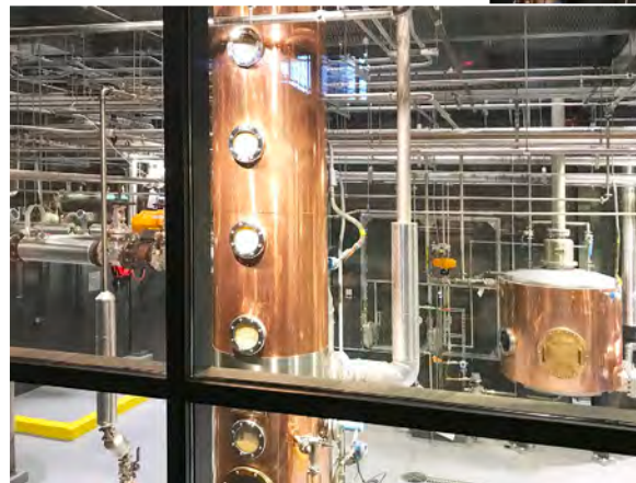
■ 地下階から高い天井の地上階まで吹き抜けで設置される、Fred B. Noe Distilleryの蒸留器。10m以上ありそうな「連続式カラムスチル」と、「単式ポットスチル」からなる。このセットを「Doubler」と呼ぶのだそう。■ 見かけは銅だが、中は上部3段のみ銅で、あとはステンレスなのだそう。ステンレスは蒸留器に適さない、という方もいるが。。
