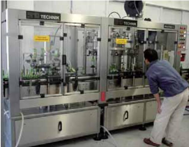
2000年4月に神奈川県熊澤酒造様(清酒「曙光」と地ビール「湘南ビール」の両方の蔵元)に、清酒・ビール兼用充填機(ドイツSMB社製「マルチマ6R/6VK/1S/1K」)を納入しました。リンサー、充填機、PPキャッパー、王冠打栓機の4つの機能がひとつになったモノブロック機。交換パーツで「一升壺」から「300cc壺」まで7種類(!)の壺形に対応可能。
