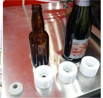
上：「センタリングベル」（壺口を押さえるパーツ）を改良、より安定した密封性能（左：BF IV 用、右の3つが BF V 用）
