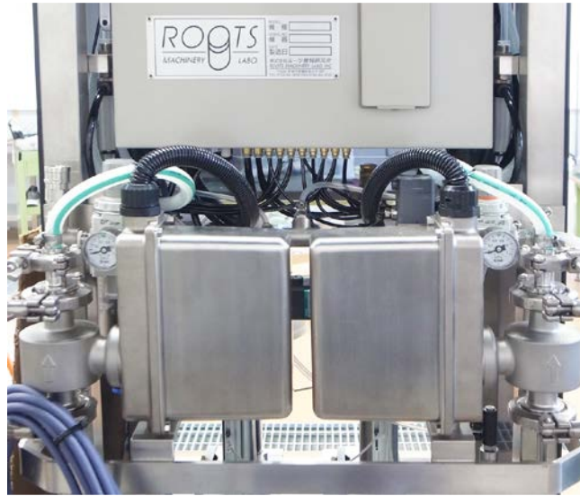
左：BF はモジュール構成。<モジュール F>が充填機本体、<モジュール C>が王冠打栓機（供給シュートと UV 殺菌装置付き）、<モジュール S>が王冠供給整列機。
