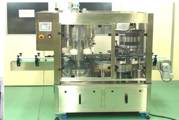
TRON 6-3C 缶詰め機 → (ガーター(樋)なし仕様) Filler-canner monoblock, without gutter
