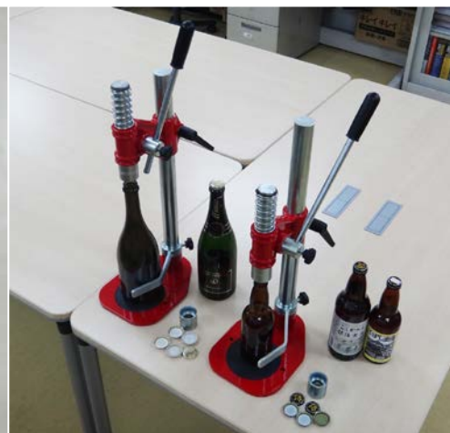
イタリアの手押し打栓機 左: シャンパン 29mm 王冠打栓ヘッドをつけた状態 右: 一般 27mm 王冠打栓ヘッドをつけた状態
