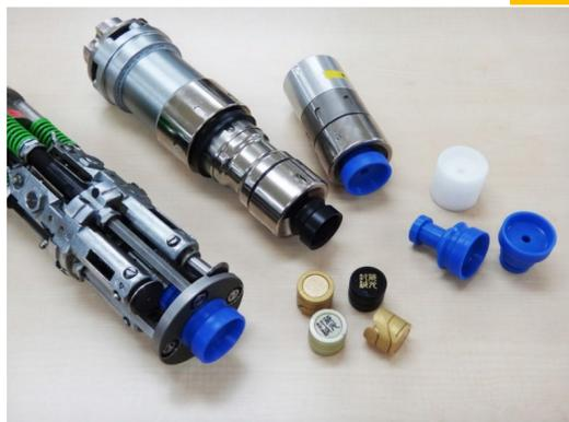
打栓ヘッドにあわせたマグネット式の「アダプター・ヘッド」を準備しています。レアアースの超強力マグネットで、ステンレスにも装着可能。
